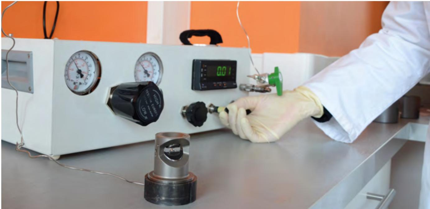
**Cellule panoramique à enclumes de diamant et son boîtier de régulation de la pression.** Ce dispositif permet d'étudier *in situ*, par spectrométrie Raman ou infrarouge ou par diffraction des rayons X, les propriétés de matériaux soumis à de très hautes pressions.
